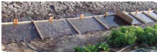
▲コンパネを切断し塩害水田に差し込んで実験区を作成
